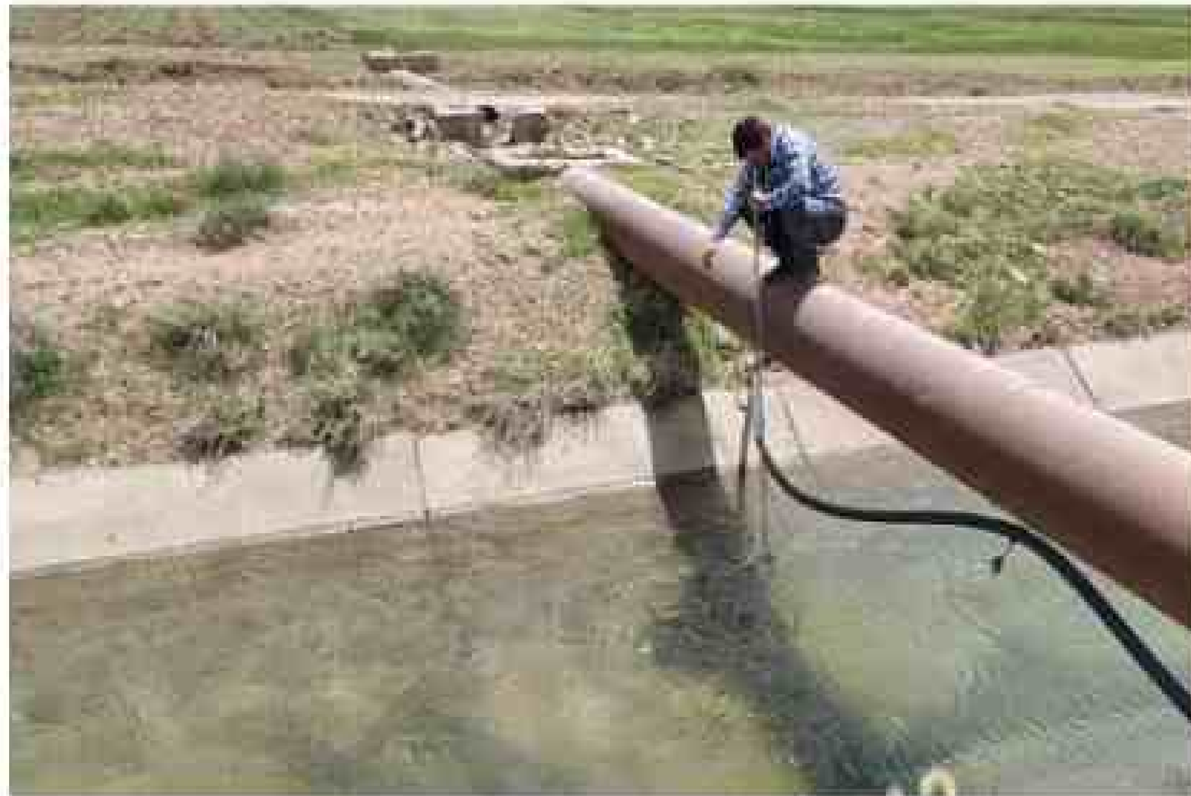
شکل ۴. نحوه داده‌برداری در مقطع دوزنقه‌ای
