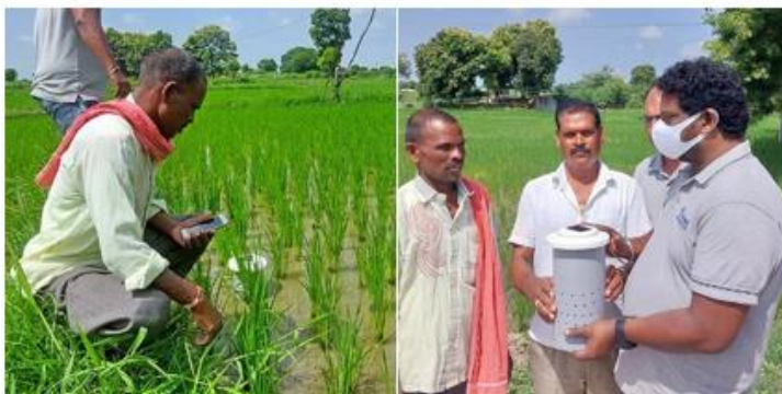
شکل ۲. نمونه ای از دستگاه مدیریت آب در مزارع پر آب بر مانند شالیزارها
