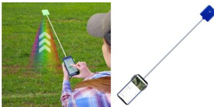
شکل ۹. نمونه‌ای از دستگاه بازتاب‌سنج و نحوه عملکرد آن
