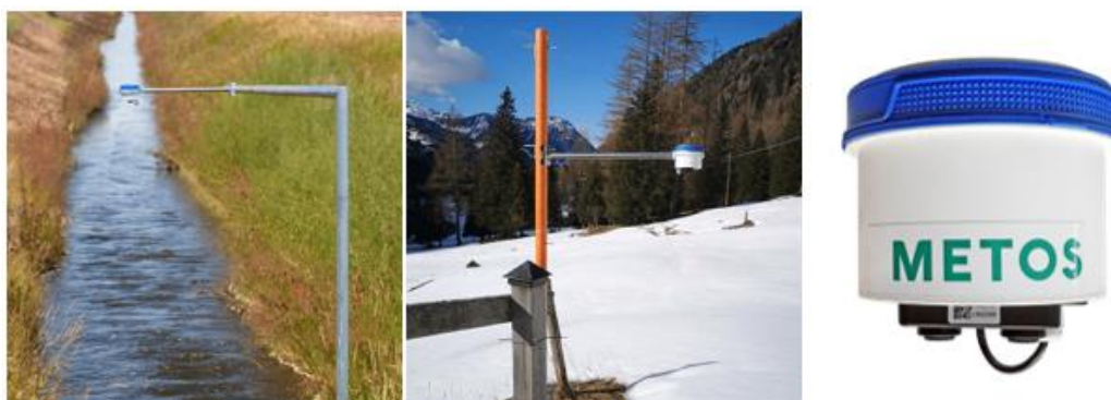
شکل ۳. نمونه‌ای از دستگاه نصب شده در بالای سطح رودخانه و ایستگاه هواشناسی
