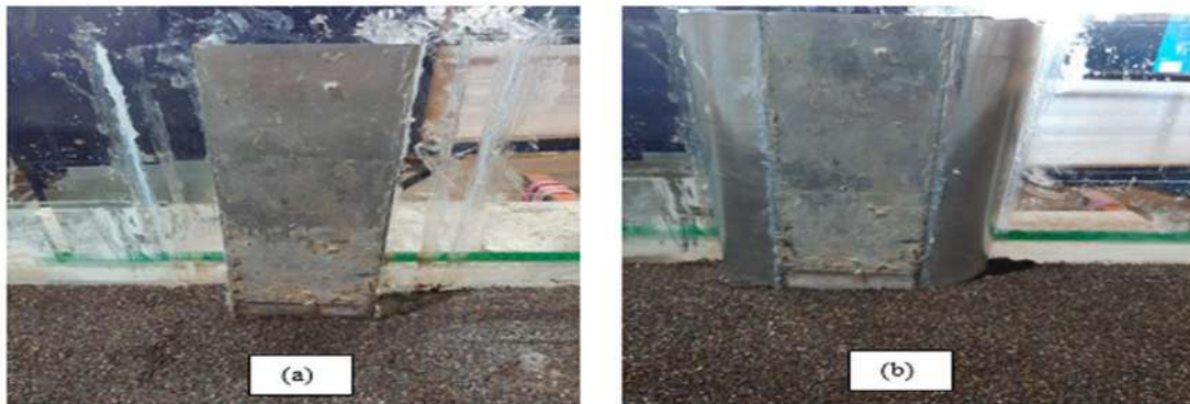
شکل ۱. نمایی از (a) تکیه‌گاه مستطیلی ۹۰ درجه و (b) تکیه‌گاه مستطیلی با باله‌های دایره‌ای
