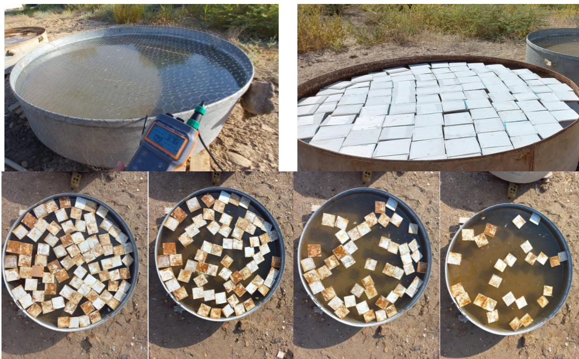
شکل ۲. پوشش‌های پلی‌پروپیلن در نسبت‌های تراکم مختلف
